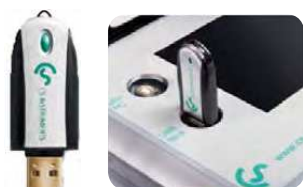
přenos dat z monitorovacích jednotek pomocí USB-disku
