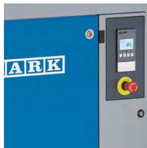
Centrální řídicí systém ES4000 Basic s monochromatickým displejem a mnoha užitečnými funkcemi pro řízení chodu
