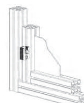
díl pro kotvení panelu k profilu
